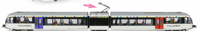
STADLER GTW 2/6 RABe 526 der THURBO AG Elektro-Gelenktriebwagen für den THURBO-Regional- und Vorortzugverkehr (S-Bahn) der Ostschweiz
